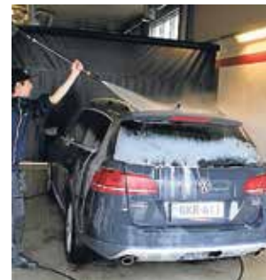
4. Auton pintaan suihkutaan vaha, jonka annetaan vaikuttaa hetken ennen kuin Tommi huuhtelee aineen pois. Vaha estää likaa tarttumasta auton pintaan ja pitää sen siistinä. Ikku-noihin laitettavan pinnottein jäljiltä sade helmeilee niiltä pois.
