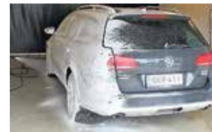
2. Auton pintaan suihkutaan pesuainetta, jonka mukana lähtevät isoimmat liat ja joka pehmentää lujempaan jäänyttä likaa auton ulkopinnolla.
